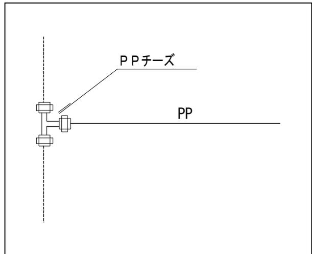
キ 「VP」「HIVP」口径40mm以下の切取り工事
