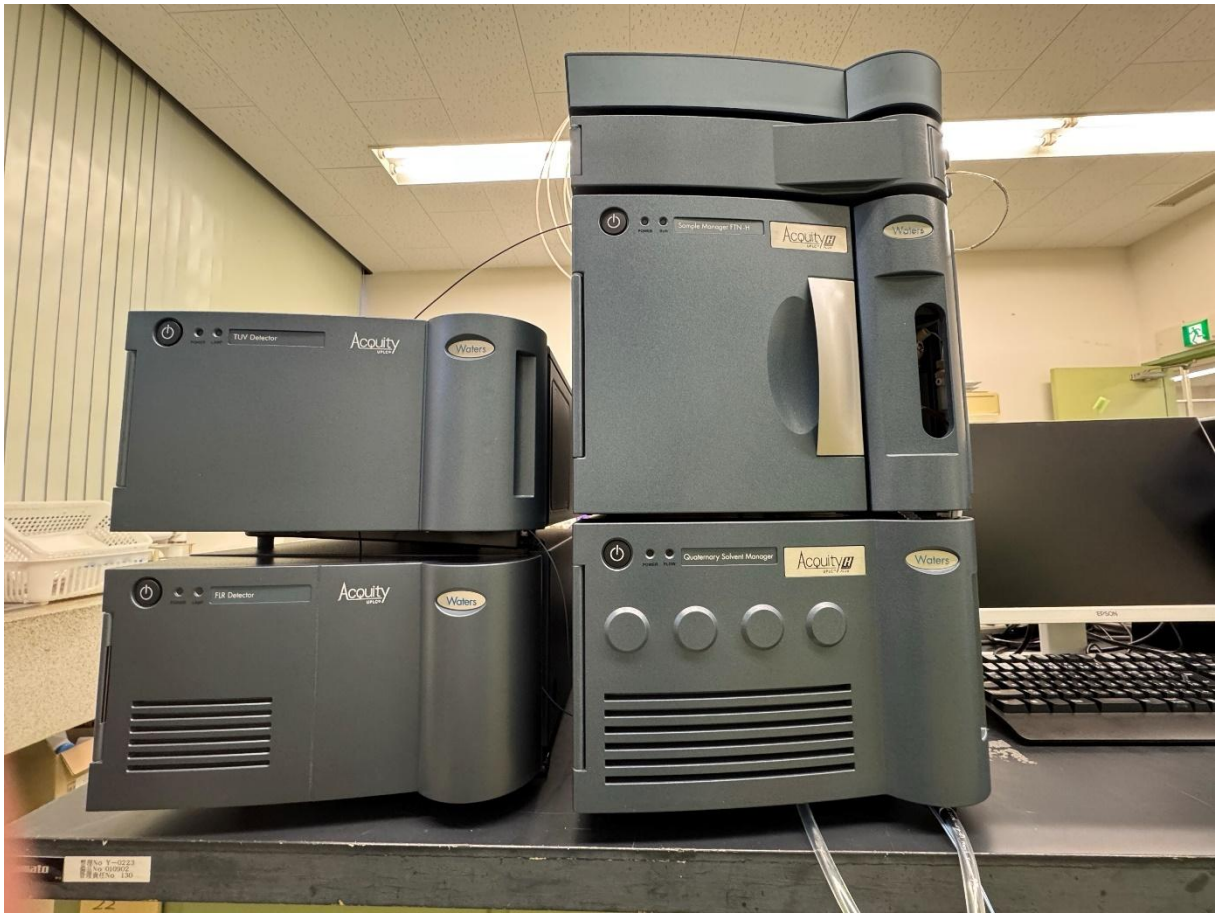
図1. 液体クロマトグラフ（ホルムアルデヒド等の測定）
