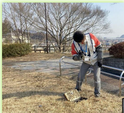
音聴棒で行う漏水有無の調査
