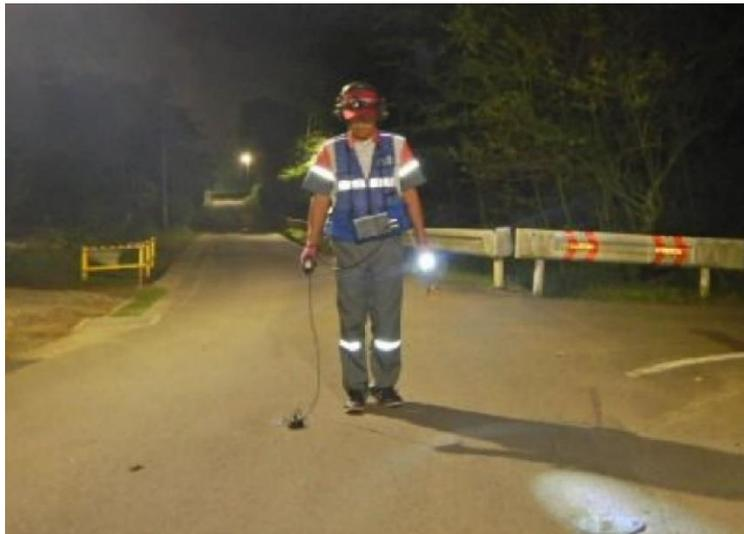
漏水探知器を使用し、路面や弁栓に伝達する音を聴音することで、漏水の有無を判別する方法である。
