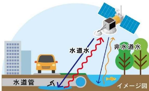
人工衛星から地下2m程度まで届くレーダーを照射し、比誘導率の違いによる反射特徴から水道水と非水道水とを区別し、それで得た画像と管路 GIS データを AI で解析し、漏水疑いがあるエリアを半径 100m で判定することができる。
